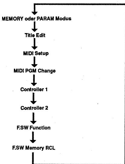
Nach der Anwahl der letzten Funktion (FSW Memory RCL) wird wieder der Modus aufgerufen, in dem sich das FX500 vor Anwahl des UTILITY Modus befand (MEMORY oder PARAM). Sie können den UTILITY Betrieb aber auch verlassen, indem Sie die UTILITY Taste drücken oder gedrückt halten, bis die UTILITY Diode wieder erlischt (ca. 1 Sekunde).
