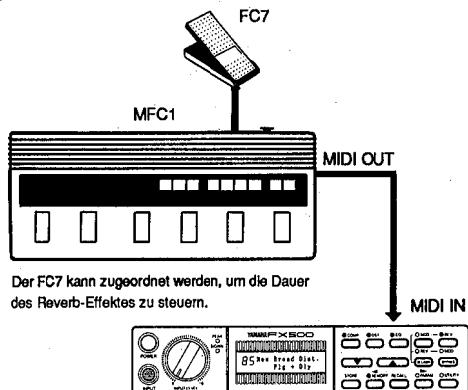
Der FC7 kann zugeordnet werden, um die Dauer des Reverb-Effektes zu steuern.
