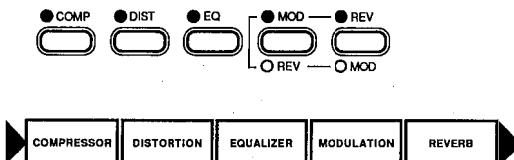
Sagen wir, Sie möchten nur den Kompressor, den Equalizer und Reverb einsetzen, dann drücken Sie die Tasten DIST und MOD, um die entsprechende Module auszuschalten.
