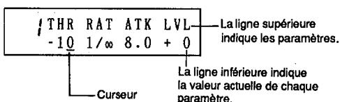
Le mode PARAM ne peut être sélectionné directement à partir du mode UTILITY en enfonceant la touche PARAM. Il faut au préalable sortir du mode UTILITY en appuyant plusieurs fois sur la touche UTILITY ou en la maintenant enfoncée pendant environ 1 seconde, jusqu'à ce que le témoin de cette touche s'éteigne.
