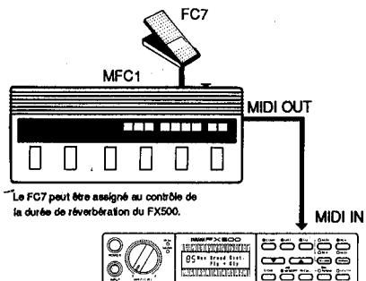
Afin de pouvoir utiliser ce genre de système, les deux "commandes" que le FX500 permet — CONTROLLER 1 et CONTROLLER 2 — doivent être réglées pour recevoir des données de changement de commande MIDI spécifiques (c'est-à-dire recevoir des données d'une commande MIDI spécifique) au moyen des fonctions Control Change 1 Table Edit et Control Change 2 Table Edit décrites ci-dessous.
