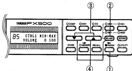
Wenn Sie die beiden Steuerelemente angewählt haben (Controller 1 und Controller 2), können Sie ihnen einen Parameter des FX500 zuordnen. Dies geschieht im PARAM Modus.
